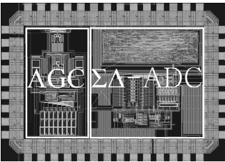
图 10 语音采集系统 (AGC 加 ADC) 版图 PGA 的不同增益如图 11 所示,最大误差为 0.2 dB,可以看出增益在对数单位下呈现出较好的线性.
